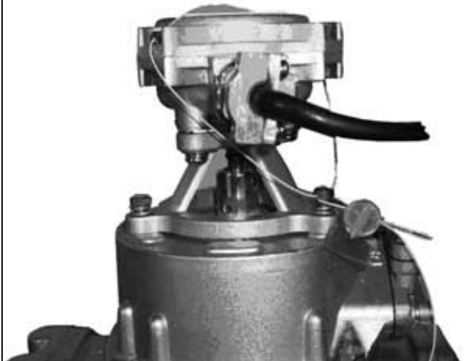
Рис.2. Пломбировка датчика расхода топлива
