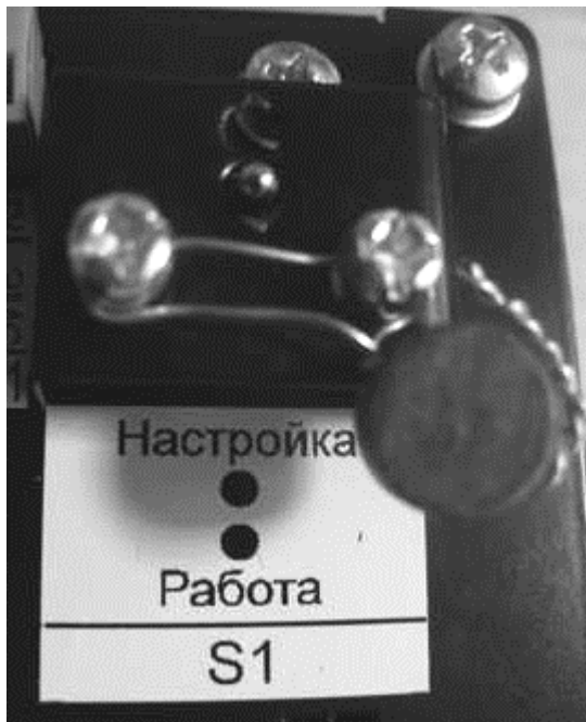
Рис.3. Пломбировка тумблера «Настройка/Работа» блока управления
